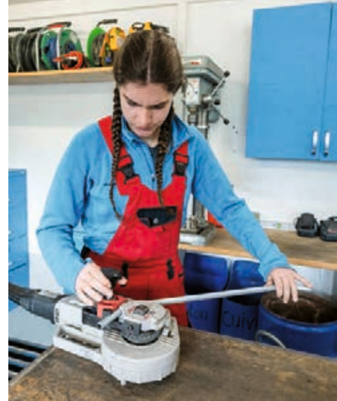
➤ In der Werkstatt biegt Lena Schuwey ein Rohr in die gewünschte Form.
