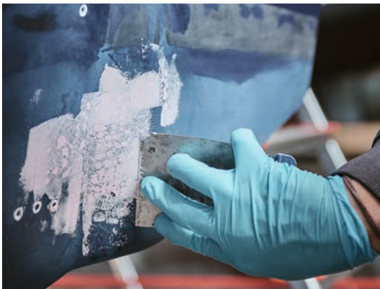
> Arbeiten mit Kunststoff Um die Dellen am Rumpf auszubessern, verwenden die Berufsleute eine Paste aus Kunstharz, das später zu einem stabilen Kunststoff aushärtet.
