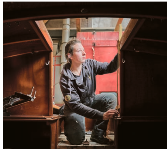
< Innenausbau Um etwa ein neues Möbelstück in ein Boot einzubauen, vermessen die Berufsleute die Kabine zuerst.
