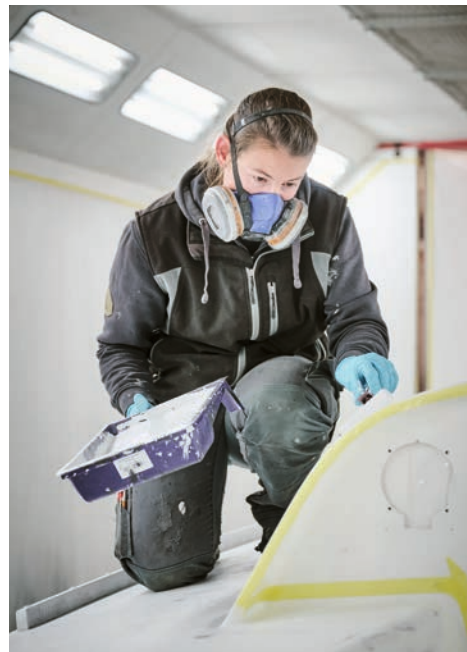
< Oberflächen lackieren Die Bootbauerinnen und Bootfachwarte tragen Lacke und Farben auf Boote in Spritzkabinen auf. Spezielle Farben streichen sie von Hand auf.
