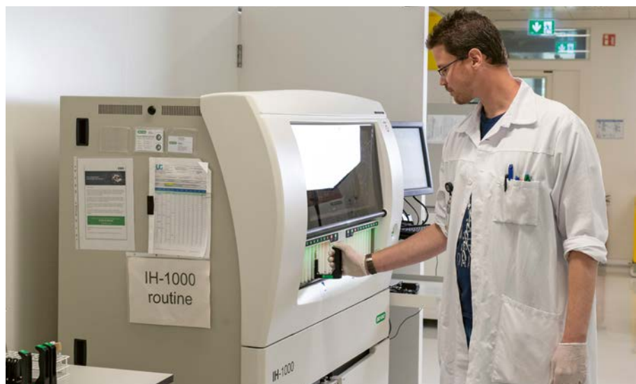
^ Gli esami del sangue automatizzati permettono d'identificare il gruppo sanguigno, l'antigene RhD e gli anticorpi irregolari.
